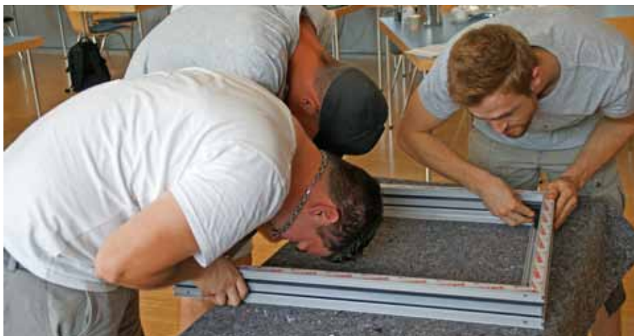
Abb. 3.: Intensive Schülerselbsttätigkeit beim Eintauchen des Dichtungsgummis in das Rahmenprofil
